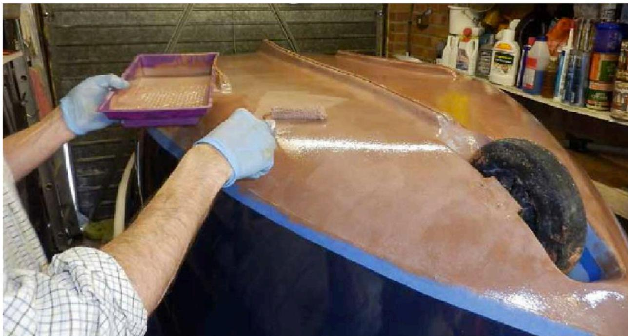
L'antifouling Coppercoat è un epoxy resin a base d'acqua utilizzabile su imbarcazioni di tutte le dimensioni. Appliciamolo dunque su un semplice tender e descriviamo minuziosamente il processo di applicazione
