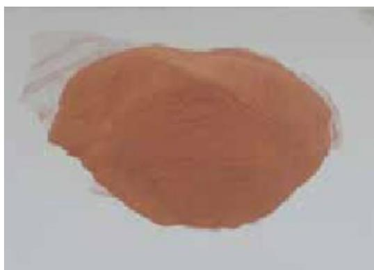
**1** La polvere di rame è molto sottile garantendo un'ottima miscelazione e buon assorbimento con la resina epossidica.
